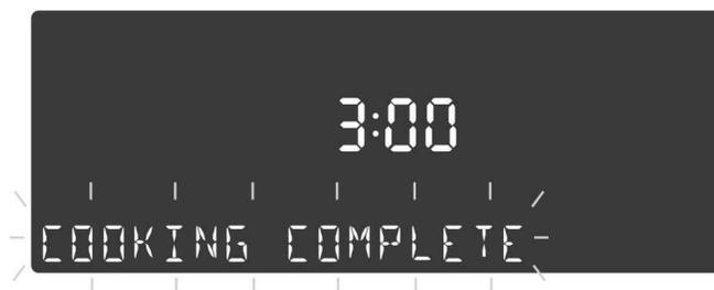
Cet écran reste dans l'affichage jusqu'à ce qu'on l'efface en appuyant sur la touche à effleurement **Oven Clear/Off** (Four Effacer/Désactiver) ou jusqu'à ce que la sonde soit retirée. Ensuite, l'écran repasse en mode Veille.
