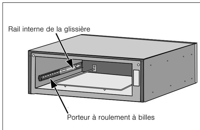
**Remarque :** Le compartiment du tiroir-réchaud devrait se trouver dans une position identique à celle de l'image ci-dessous avant de commencer l'installation. Le porteur à roulement à billes devrait être verrouillé en place dans le bout en plastique noir du rail intérieur situé sur la partie avant du rail intérieur.
