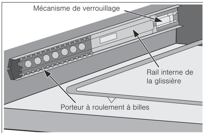
1. Sans que le tiroir ne soit en place, faites glisser le rail intérieur de la glissière jusqu'à la position de verrouillage du tiroir en poussant le rail intérieur de la glissière **vers l'arrière** jusqu'à ce qu'elle se verrouille en place.
