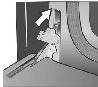
5. Poussez les leviers sur les deux charnières vers le haut jusqu'à ce qu'ils soient bloqués dans le logement en affleurement de la partie avant du bâti du four.
