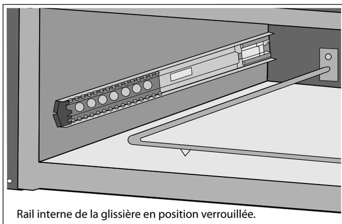
2. Placez l'assemblage du tiroir devant l'assemblage du compartiment et alignez le rail (bout en plastique du rail) avec l'assemblage du porteur à roulement à billes. Tout en gardant l'assemblage du tiroir droit et au niveau par rapport au compartiment, insérez doucement le tiroir dans l'assemblage du compartiment.
