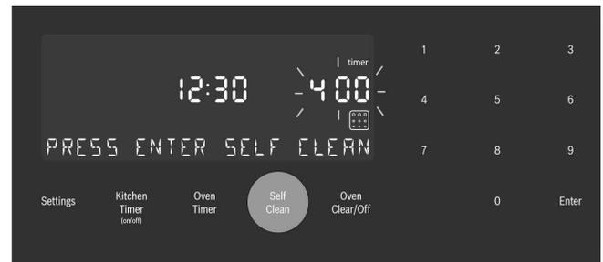
4. Lorsque la durée d'autonettoyage désirée est affichée, appuyer sur **Enter** sur le pavé numérique.
