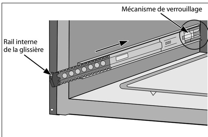
**Remarque :** Une force modérée exercée sur le mécanisme de verrouillage du porteur à roulement à billes noir en plastique est requise pour placer la glissière dans la position de verrouillage du tiroir. Le tiroir est verrouillé lorsqu'il demeure en place et ne revient pas automatiquement en position ouverte.
