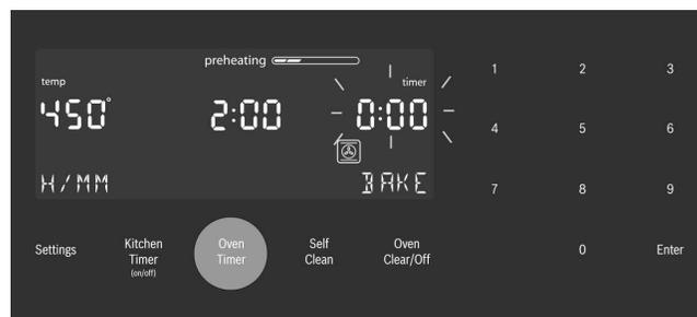
Appuyer sur la touche à effleurement **Enter**. La minuterie du four lance le compte à rebours jusqu'à 0:00.
